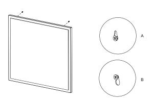
Encaixe a espelheira na parede. Posicione-a alinhando o furo maior da alheta com o parafuso fixo na parede. Obs.: a cabeça do parafuso passará pelo furo maior (A) da alheta e encaixará no furo recortado menor (B).
