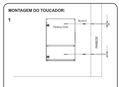
Posicione o toucador na parede de forma que esteja nivelado (utilize um nível) e marque com lápis os furos na parede, passando-o pelos furos do toucador. Afaste o toucador da parede e com uma trena ou metro confirme se as medidas entre as marcações estão conforme os furos do toucador. Fure a parede com broca n.8. Coloque a bucha 8 nos furos, posicione o toucador alinhando os furos com as buchas na parede.
