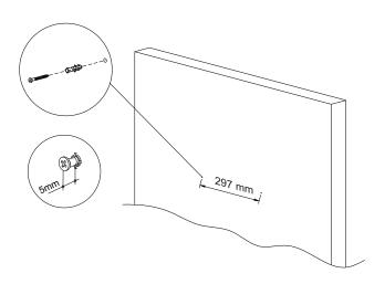
Faça as marcações na parede observando a medida de 297 mm entre os furos, e o alinhamento vertical até o piso. Após confirmadas as medidas, fure a parede com uma broca 6 e coloque as buchas 6 na parede. Fixe os parafusos 4x40 nas buchas deixando 5 mm para fora, para encaixe nas alhetas da espelheira.
